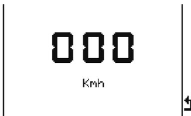
Sobald eine Geschwindigkeit von mehr als 0 erkannt wird berechnet das ADSGPS die Leistungsdaten des Fahrzeugs. Es ist dann erforderlich eine Beschleunigung durchzuführen, mindestens 160 km/h zu erreichen, mindestens 1000 m zurückzulegen und von 100 auf 0 km/h abzubremesen, um SÄMTLICHE Informationen zu erhalten.
