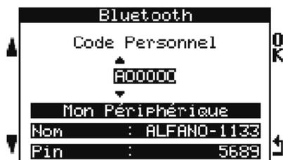
Zeigt die Bluetooth-Parameter Ihres ADSGPS für eine Verbindung zu einem anderen ADSGPS oder einem PC mit Alfano-Bluetooth-Dongle (Adapter) an. Hier findet sich der Name des ADSGPS (z.B. ALFANO-1133), der Pin-Code/Windows-Zugangsschlüssel (z.B. 5689) und der persönliche Code, den Sie ändern können, um Ihre Daten bei einer Verbindung zu schützen.
